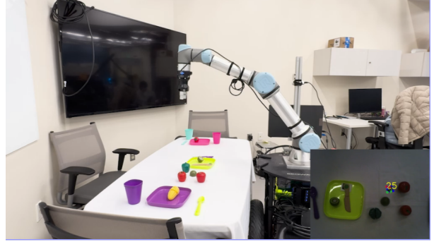
(d) Robot detects a situation and trigger active perception.
